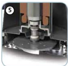
Járókerék AISI 304 Króm-nikkel acél
